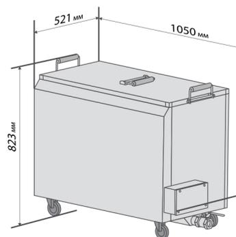
**ЭКСПЛУАТАЦИЯ:** Регулярно не менее 1 раза в месяц требуется сливать раствор, очищать бак внутри и снаружи, заполнять чистой водой и моющим средством. Обслуживание Устройства осуществляется сервисной службой ТАЙГЕТА.
